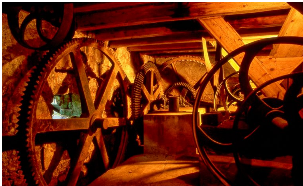
Mühlradgetriebe der Rosselmühle bei Thaleischweiler-Fröschen (Bernd Wagner, 2018)
