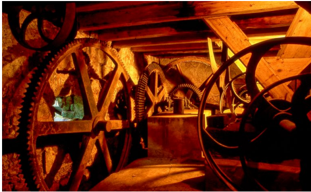
Mühlradgetriebe der Rosselmühle bei Thaleischweiler-Fröschen (Bernd Wagner, 2018)
